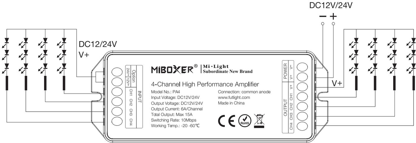
**Esquema de instalación 41.022 “4 canales” con amplificadores**
